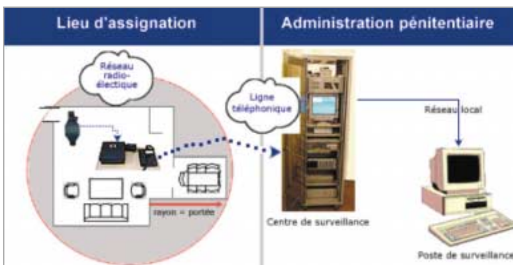
Schéma de la surveillance statique
